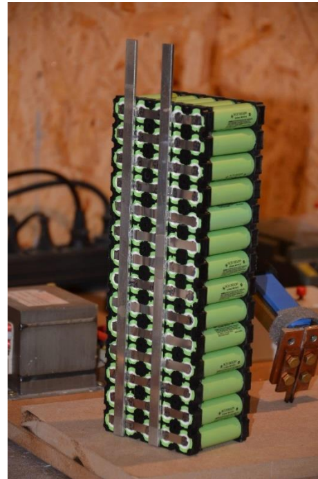
Ci-dessus un assemblage série-parallèle de 70 cellules de type 18650
